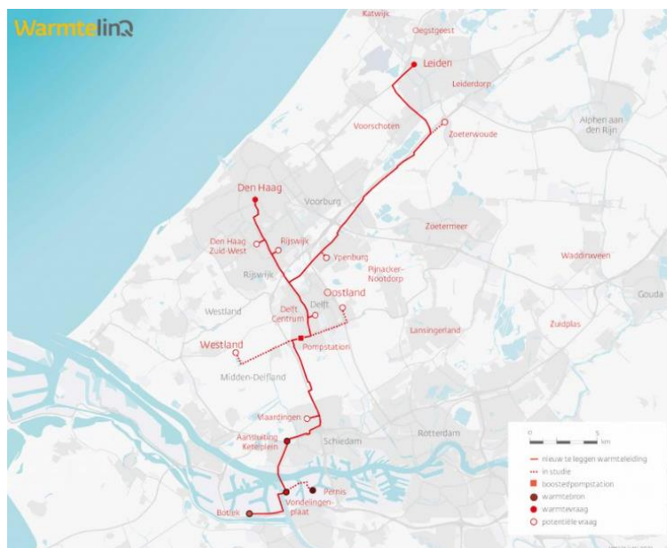
Figuur 11. Mogelijk tracé van de toekomstige transport-warmteleidingen tussen Rotterdam en Den Haag. Bron: www.warmtelinq.nl
