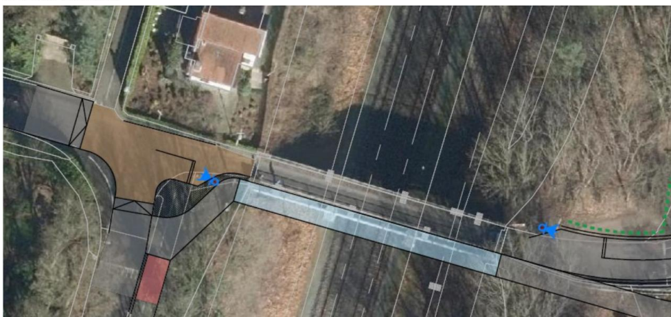
Afbeelding 4.2. Een VRI met aan weerszijden van het viaduct een licht
