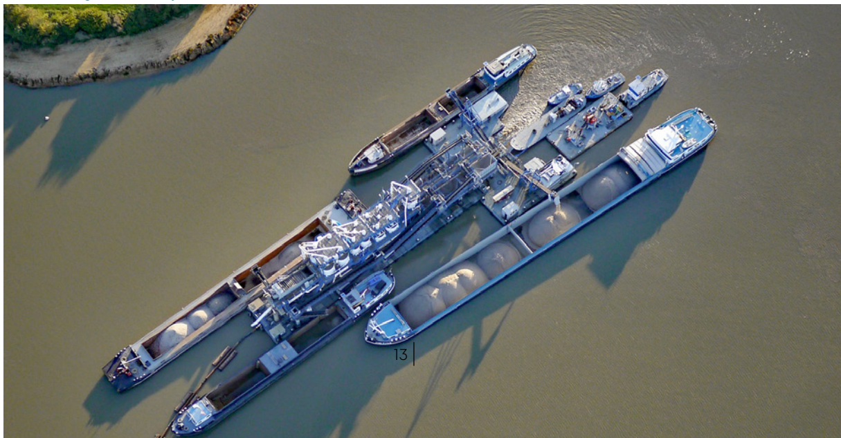
Zandwinning met een drijvende installatie, Teunesen
