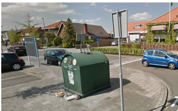
Figuur 25: Zichtbelemmerende objecten ter hoogte van oversteekplaats en kruispunt
