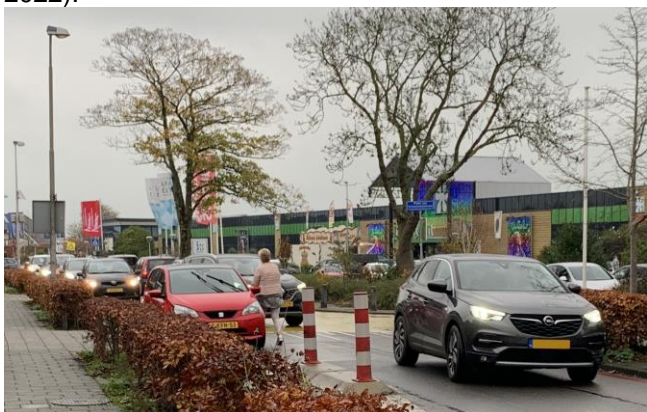
Figuur 5: Terugslag achter geparkeerde auto bij wegversmalling. Te zien is de ontstane wachtrij en passerend verkeer.
