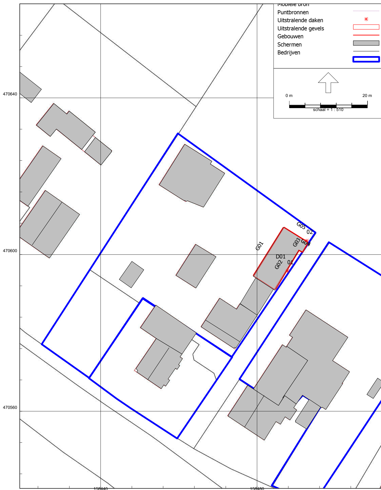
figuur 5a: Overzicht rekenmodel met positie geluidbronnen
