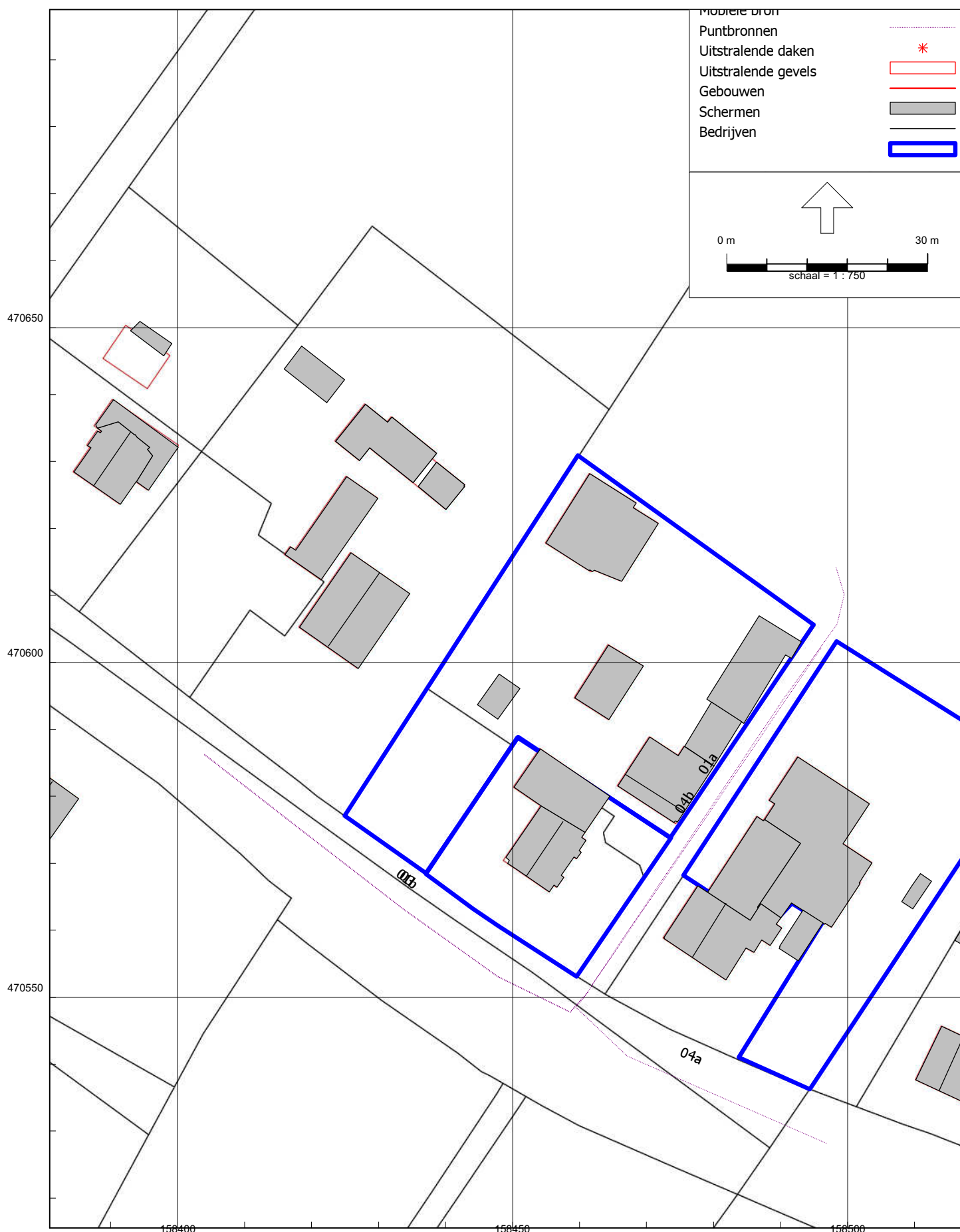
figuur 6: Overzicht rekenmodel met positie geluidbronnen
