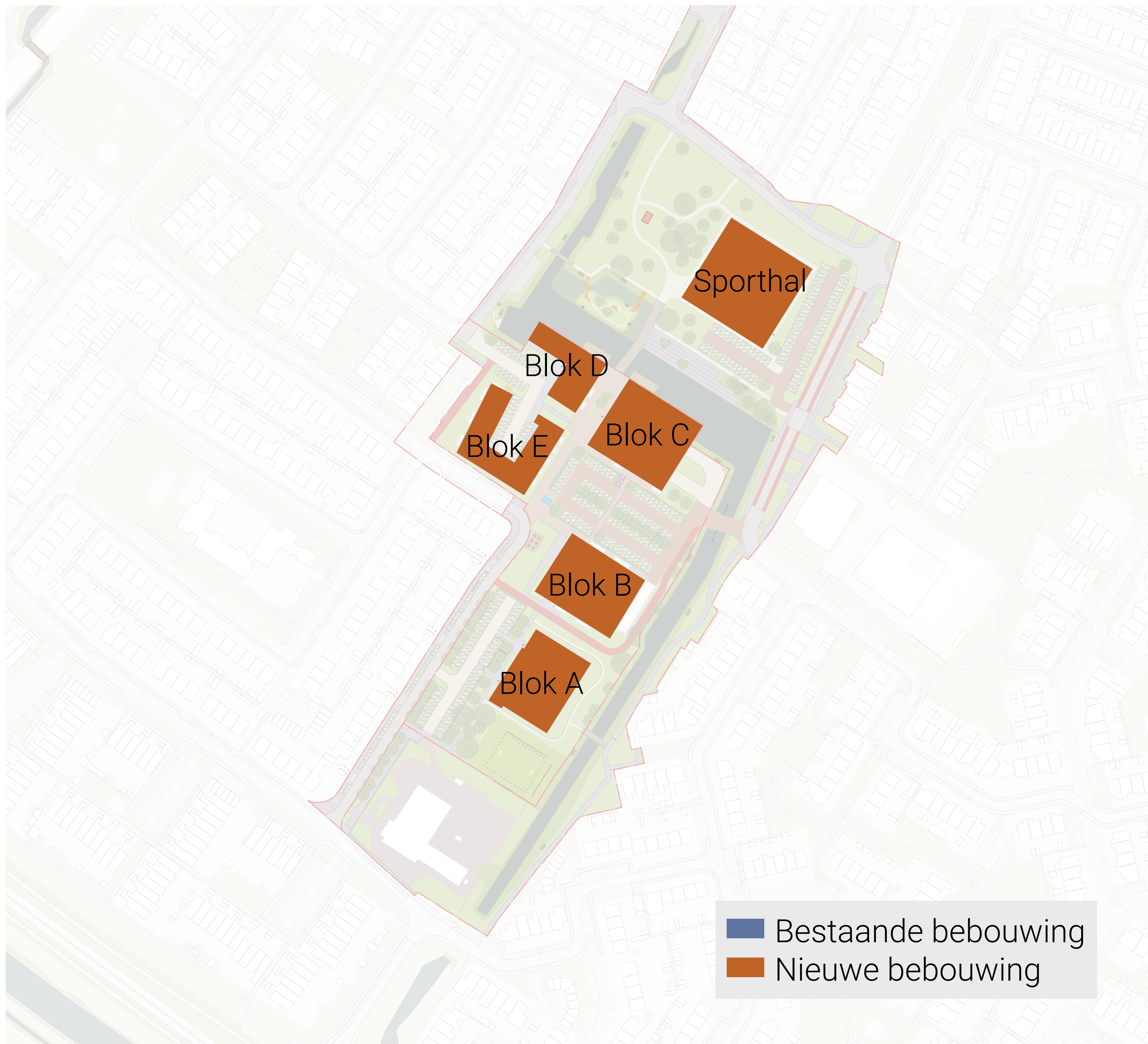
Fase 3: Sloop sporthal en realisatie blok B. Sloop Goudenregenlaan 1. Sloop 12 woningen WSN na 2030 en start realisatie blok E.
