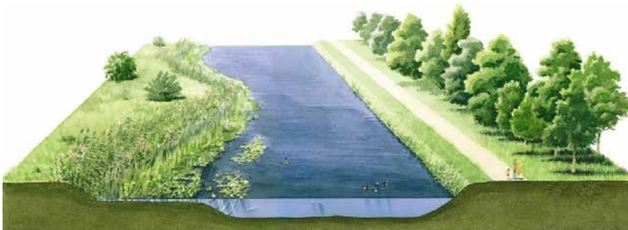
Figuur 5: Reguliere oever (rechts) en een natuurvriendelijke oever (links), met een veel flauwer talud en daardoor meer ruimte voor waterplanten. (bron figuur: www.waterschaprivierenland.nl )
