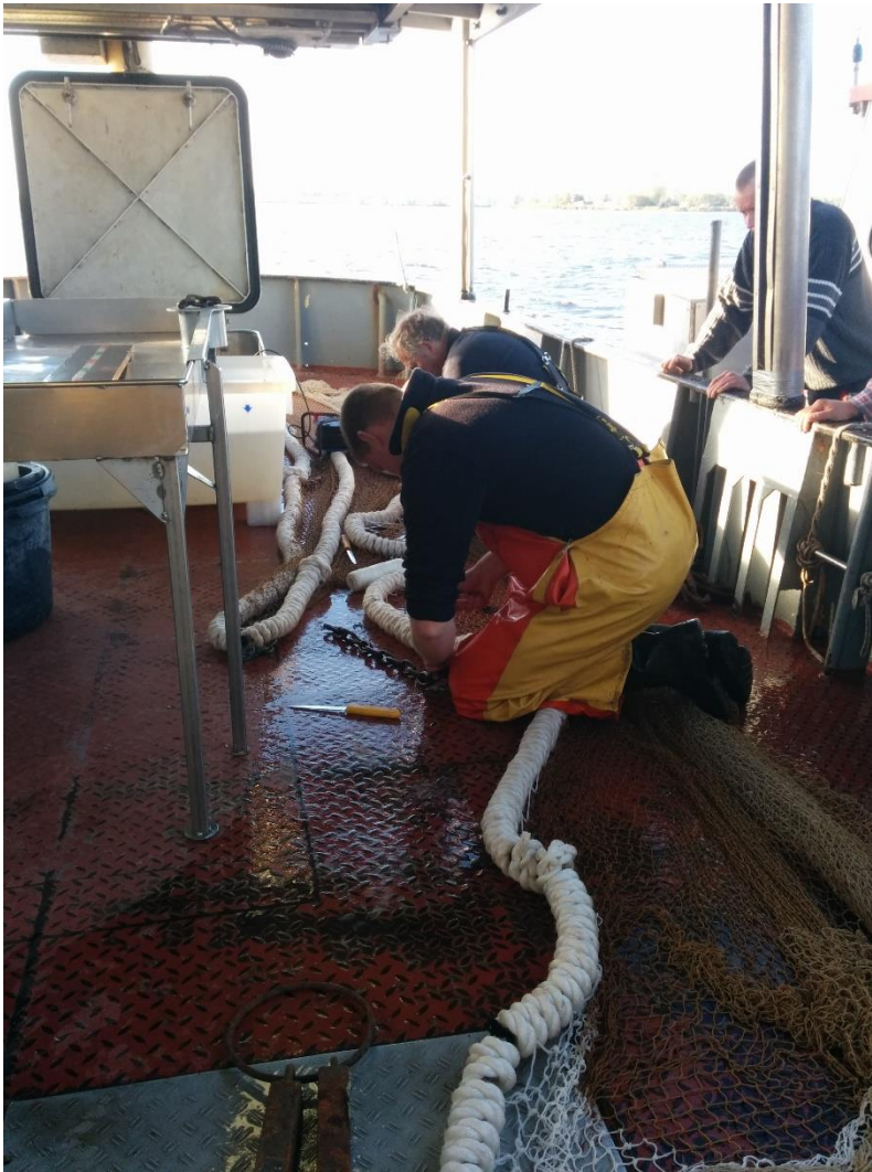
Figuur 14 Het verzwaren van de onderpees zodat de stortkuil netjes over de bodem heen gaat.
