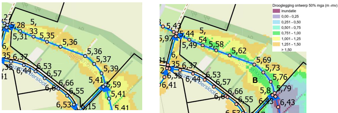
Figuur 5-4 Drooglegging aandachtslocatie B bij 50% maatgevende afvoer in de huidige (links) en doorgerekende ontwerpsituatie (rechts)
