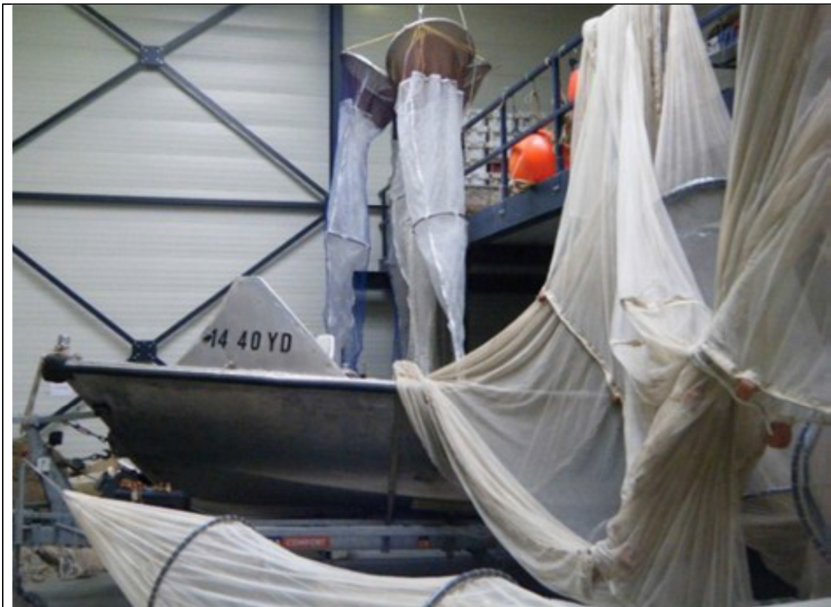
Figuur 3.7 Trechtvormige kleine netten en stramienfuik voor bevissing schutsluiskolk
