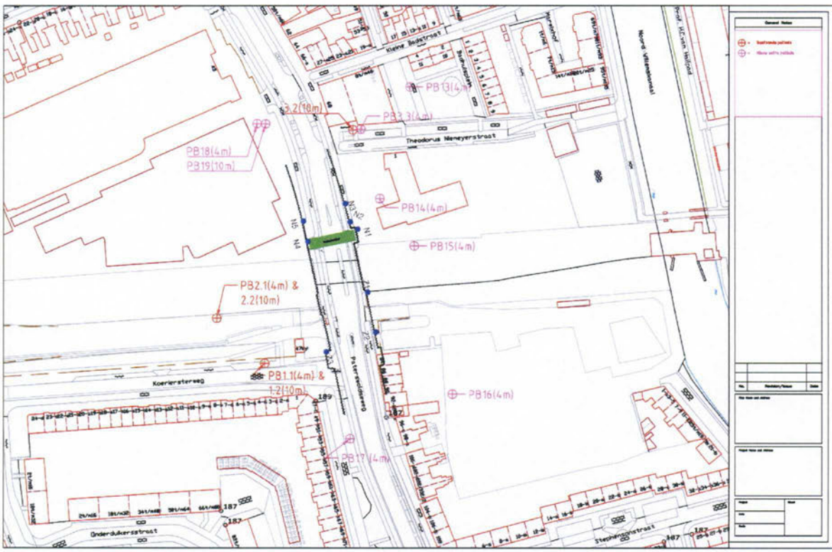
Figuur 4: Overzichtkaart nieuw geplaatste peilbuizen. Deze peilbuizen zijn allen in de freatische laag geplaatst.
