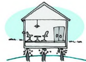
Grondwaterpeil te laag: paalrot
