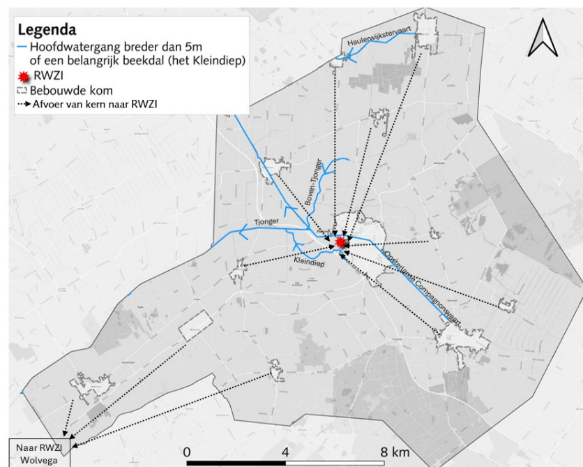
Figuur 4-1. Schematische schets van het afvalwatersysteem van Ooststellingwerf
