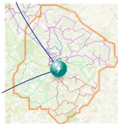
Voorbeeld: Winterswijk. Het voedingsgebied van het onderstation beslaat de hele gemeente. Elke kleur in deze kaart is één middenspanningsroute.
