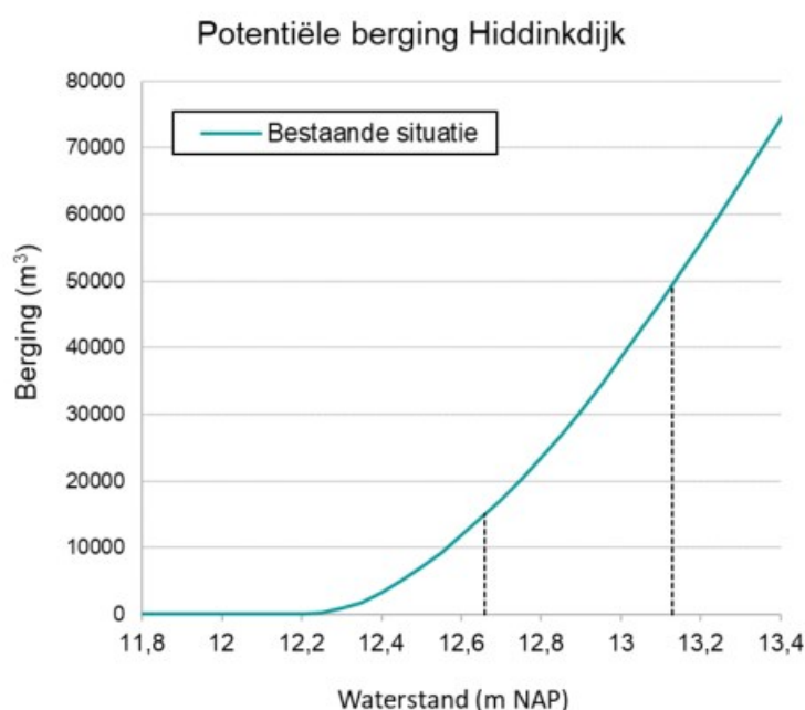
Figuur 3-1 Bergingscurve Hiddinkdijk inclusief de theoretische berging in het T100-scenario (12,65 m NAP) en T1000-scenario (13,13 m NAP).
