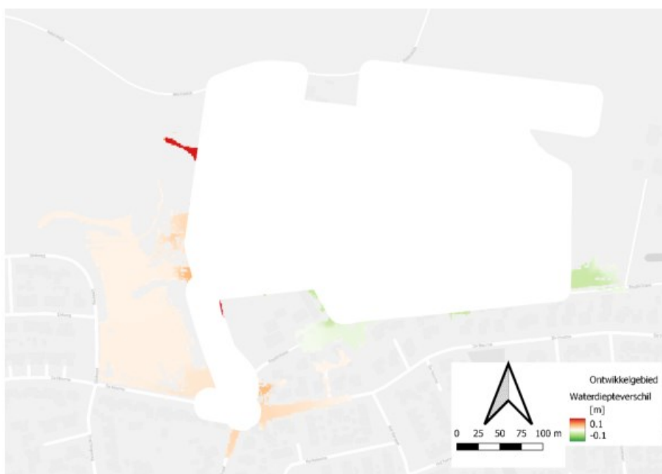
Figuur 5-6 Waterdiepteverschil maatregelvariant 3 ten opzichte van bestaande situatie. Rood geeft aan waar de maximale waterdiepte toeneemt, groen geeft aan waar de maximale waterdiepte afneemt.
