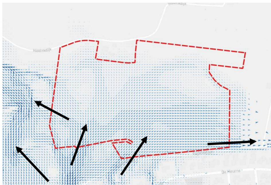
Figuur 3-11 Stroombanen tweede afvoergolf huidige situatie in T1000-scenario
