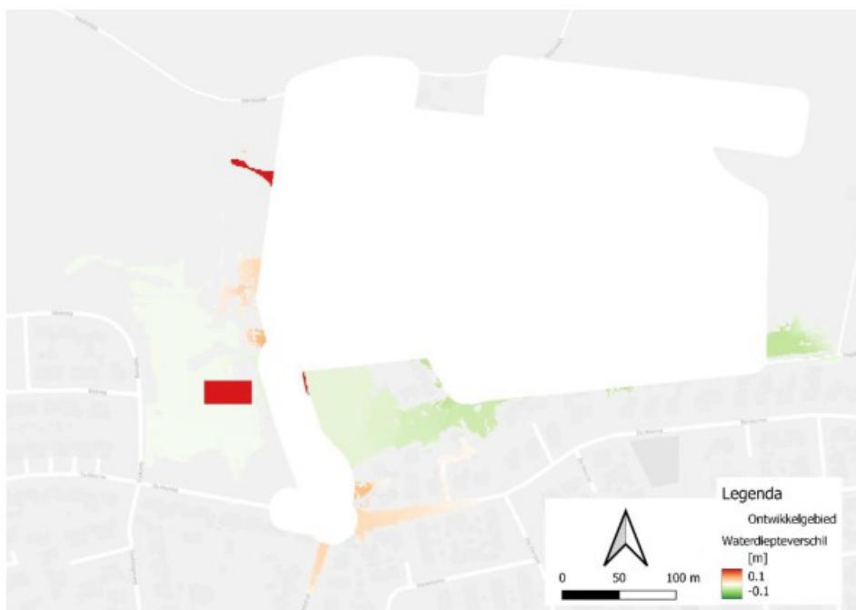
Figuur 5-9 Waterdiepteverschil maatregelvariant 4 ten opzichte van bestaande situatie. Rood geeft aan waar de maximale waterdiepte toeneemt, groen geeft aan waar de maximale waterdiepte afneemt.
