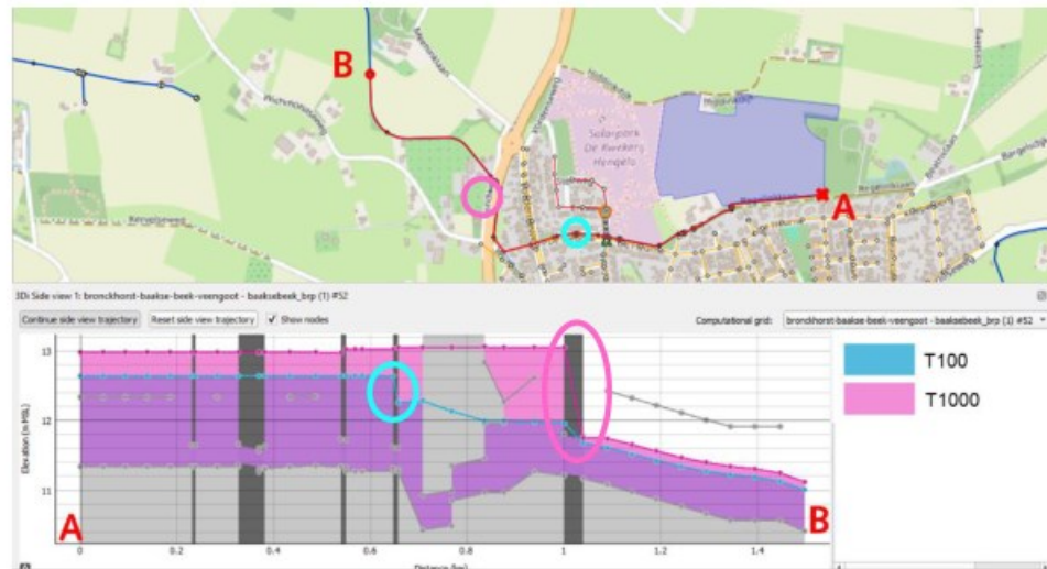
Figuur 3-13 Langsdoorsnede watergang met maximale opstuwing huidige situatie
