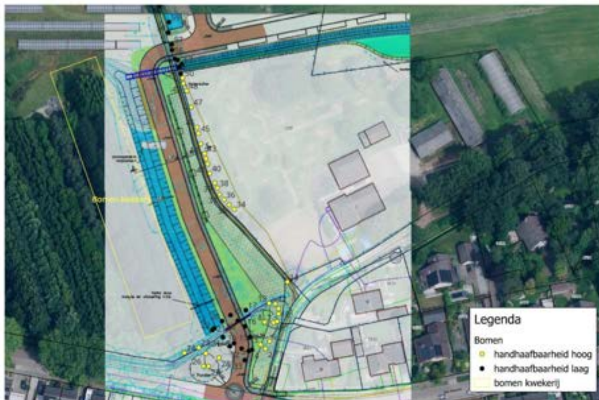
Afbeelding 8. Bomen die als gevolg van de toegangsweg komen te vervallen (zwart) en de nieuwe greppel in blauw. Onder de toegangsweg komt een duiker (bron: boomadvies , 2025)
