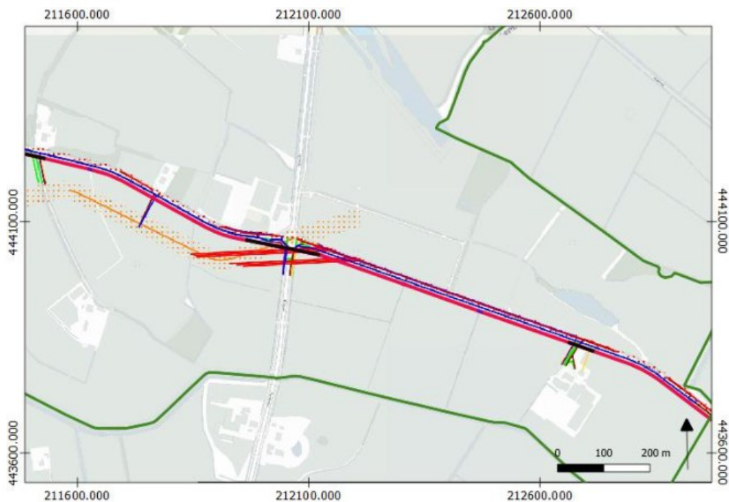
Afbeelding 11. Het plangebied op de KLIC-kaart. De open ontgravingen zijn weergegeven met een rode lijn en de HDD delen met een zwarte lijn.
