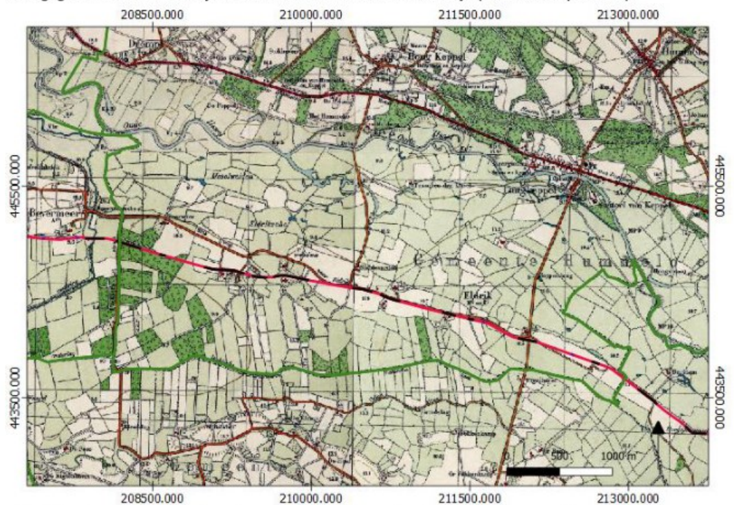
Afbeelding 9. Het plangebied op de topografische kaart uit 1950. De open ontgravingen zijn weergegeven met een rode lijn en de HDD delen met een zwarte lijn (bron: Esri & partners).
