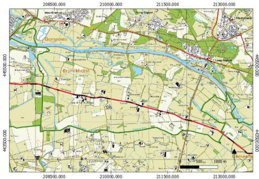
Afbeelding 10. Het plangebied op de topografische kaart uit 2019. De open ontgravingen zijn weergegeven met een rode lijn en de HDD delen met een zwarte lijn (bron: Esri & partners).
