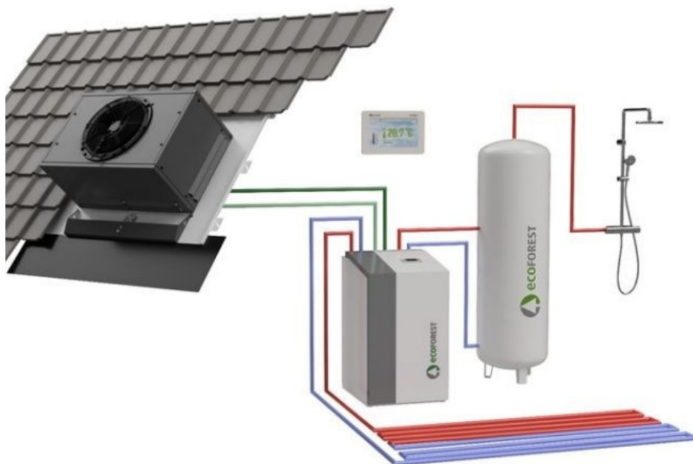
Figuur 2.4 | Individuele lucht-/waterwarmtepomp 4 .
