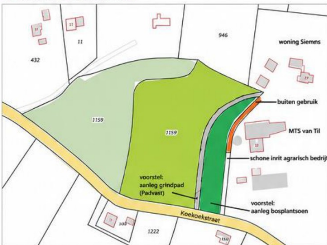
Figuur 5 Situatietekening nieuwe uitrit en landschappelijke inpassing (indicatief)
