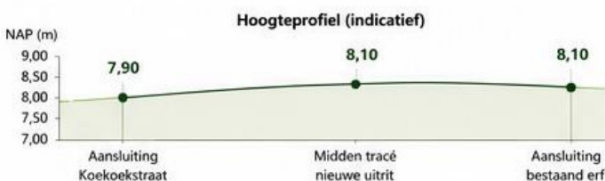
Figuur 4 Hoogteprofiel nieuwe uitrit (lengte indicatief)
