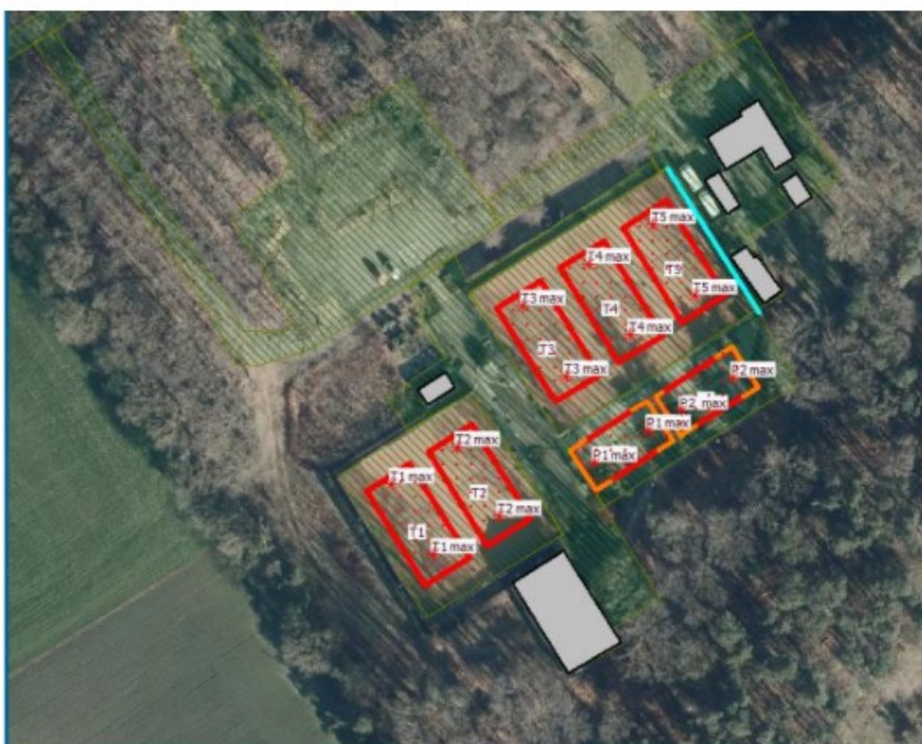
Afbeelding 4.1: Geluidscherm ten oosten van de tennisbanen (blauwe lijn)
