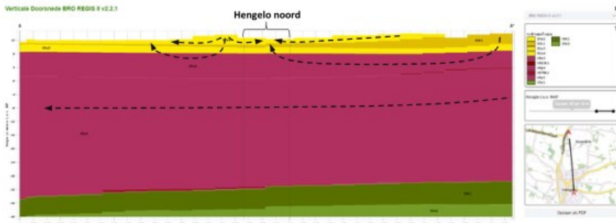
Figuur 4: Regionale schematische dwarsdoorsnede Regis II, raai noord -zuid (TNO NITG, 2022). De zwarte pijlen geven de verwachte grondwaterstromingen in de verschillende watervoerende pakketten weer
