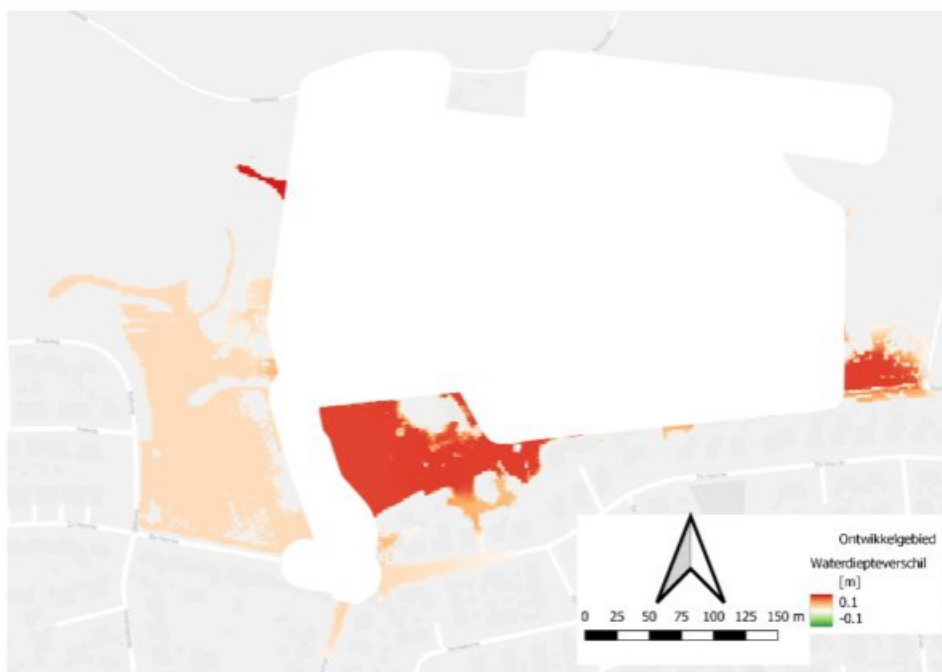
Figuur 4-3 Waterdiepteverschil toekomstsituatie t.o.v. bestaande situatie in T100-scenario. Rood geeft aan waar de maximale waterdiepte toeneemt, groen geeft aan waar de maximale waterdiepte afneemt.
