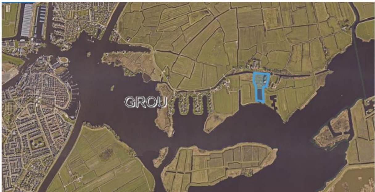
Figuur 2: Luchtfoto uit 2022 met blauw opgelicht het perceel Burd 20. Deze luchtfoto maakt inzichtelijk dat er 25 hectare landbouwgrond is afgegraven met als gevolg dat er een nieuw meer en eiland is ontstaan. Op het perceel Burd 20 is een opvaart/haven afgegraven die in verbinding staat met dit meer.
