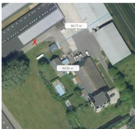
Figuur 15 afstanden propaantank ter plaatse
