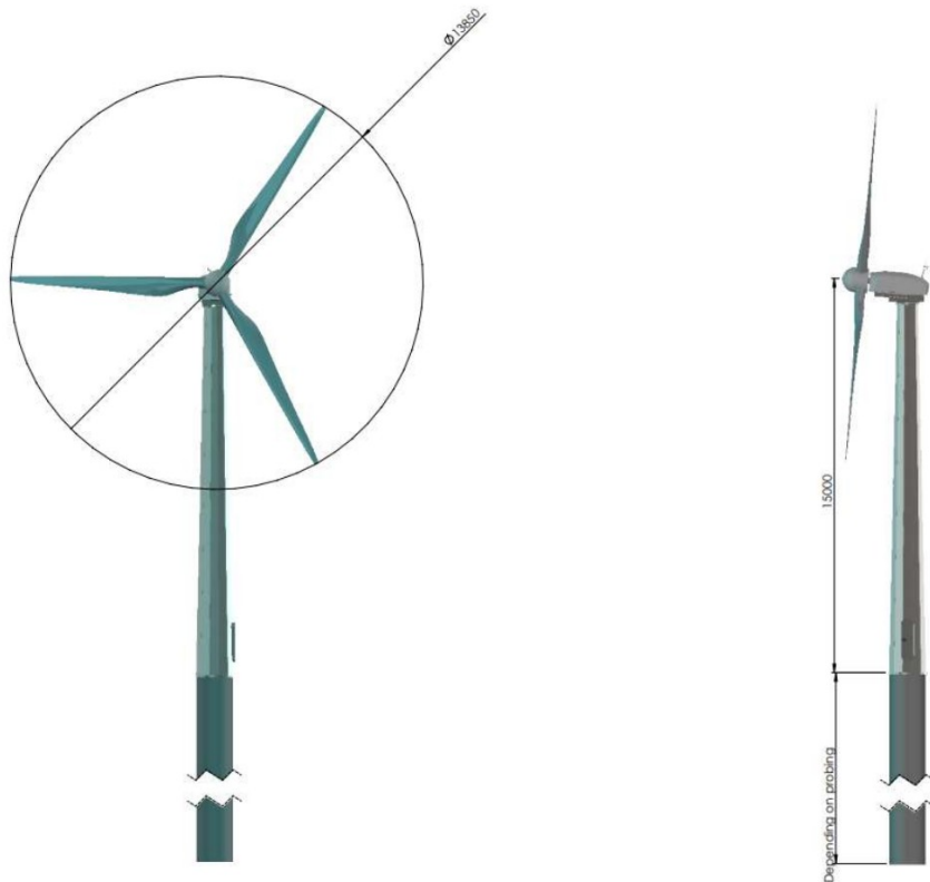
Figuur 2. De molen met een rotordiameter van 13,85 meter en een as-hoogte van 15 meter
