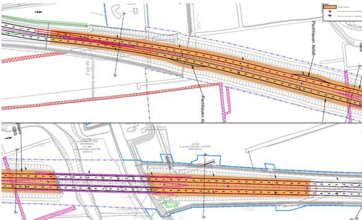
Figuur 3: Locatie LD Staalslakken (oranje) in de N365 bij het viaduct over De Falomster Feart (staalslakken in oranje) [bron 1]
