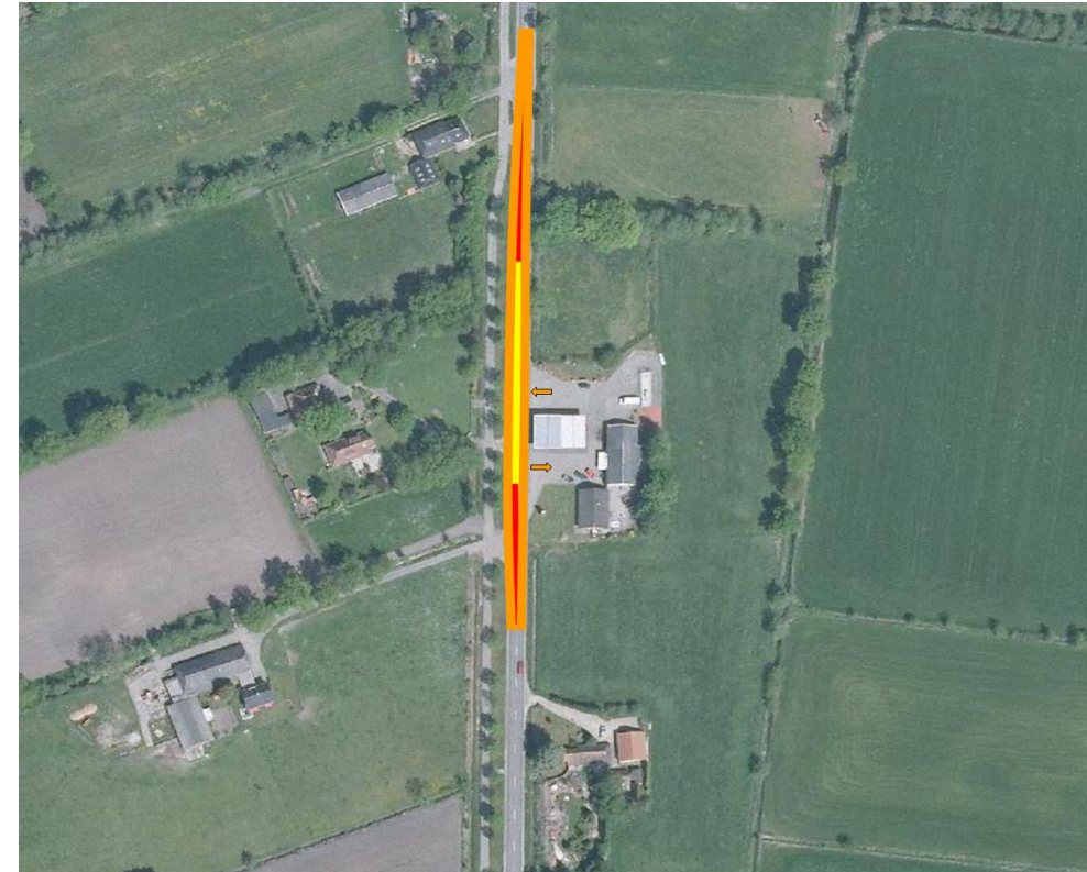
b. linksafvak + eenrichtingsverkeer op terrein tankstation
