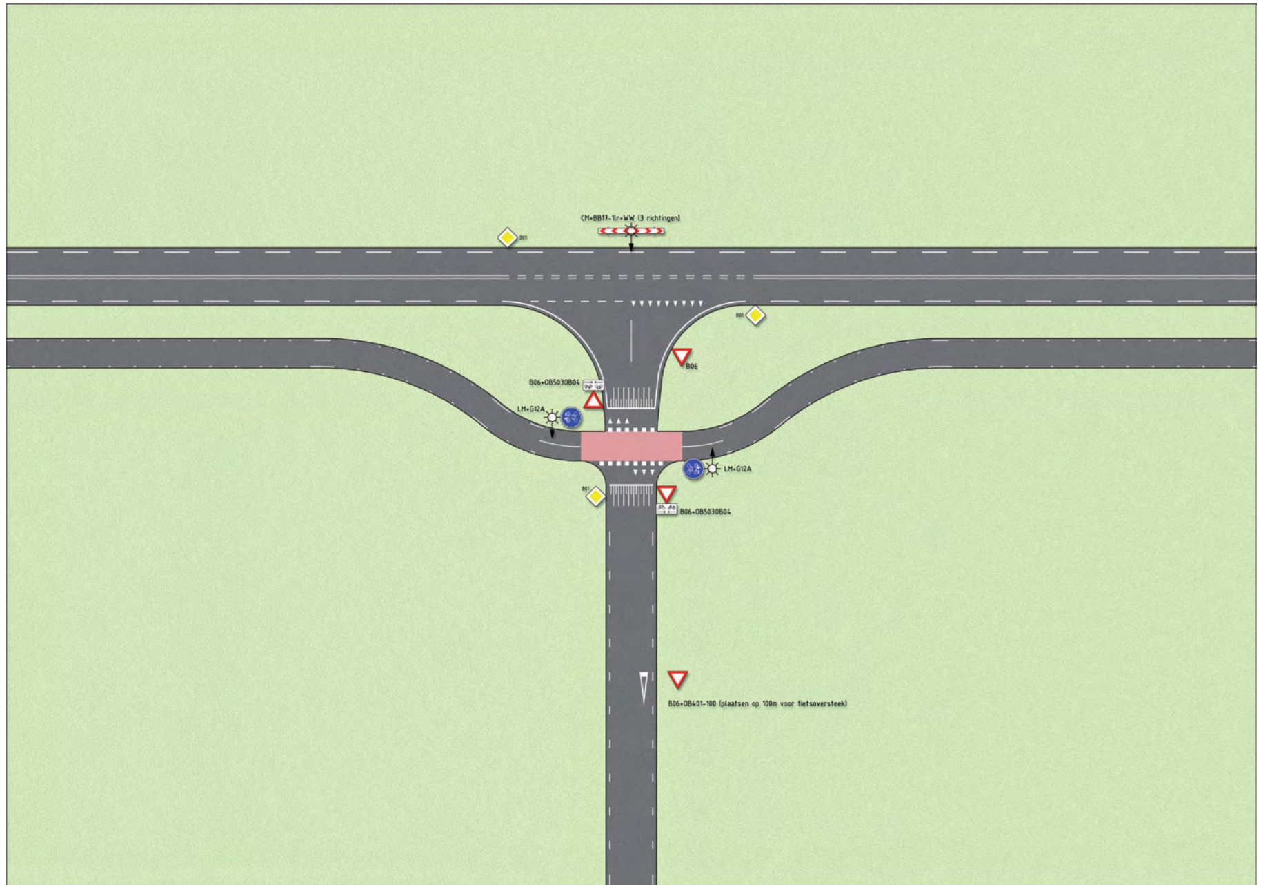
Voorkeursontwerp en inrichting van de fietsoversteek met voorrang op de aansluitende zijweg
