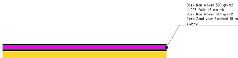
Figuur 7 - opbouw constructie afdekking
