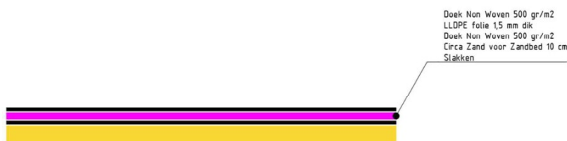
Figuur 7 - opbouw constructie afdekking
