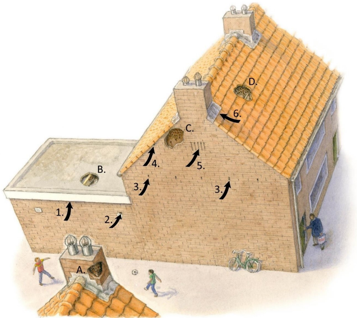
Figuur 3. Locaties die door onder andere de meervleermuis als toegang en als verblijfplaats gebruikt kunnen worden. Verblijfplaatsen zijn met A-D aangegeven, toegangsoeningen met 1-5. Afbeelding: Peter Twisk.
