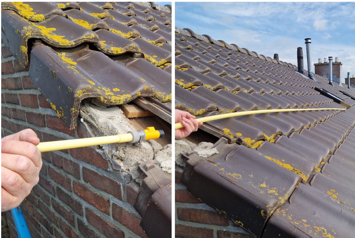
Figuur 2. Met een kleine inspectiecamera van 2 cm dik (foto links) en een 4 m lange flexibele buis (foto rechts) werd de onderzijde van dakpannen gecontroleerd op sporen van vleermuizen.
