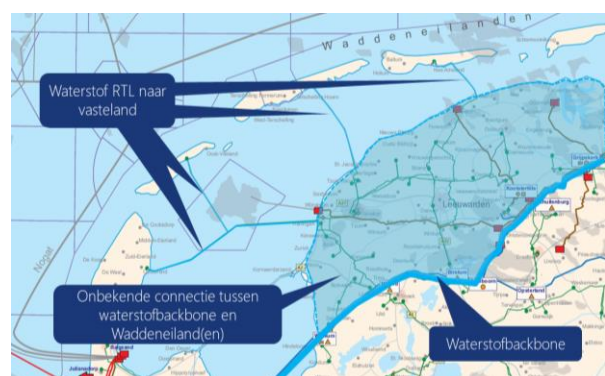
Figuur 35: De impact van een waterstofleiding tussen de één of meerdere Waddeneilanden en de waterstofbackbone op de gasnetten in Fryslân.
