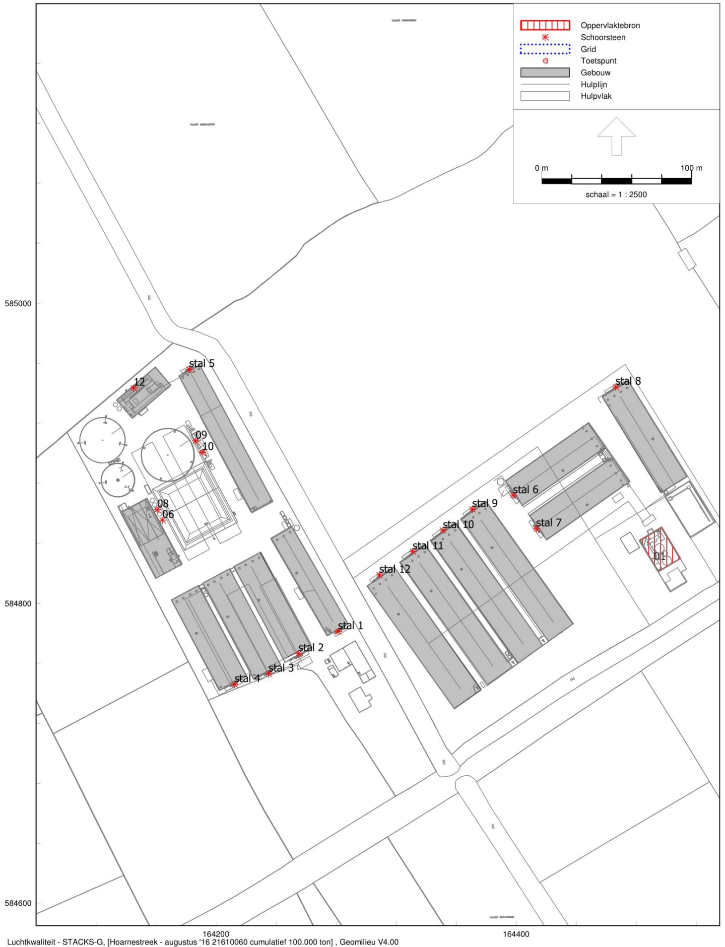
Pluimveebedrijf + co-vergistingsinstallatie 100.000 ton/jaar - Overzicht van het rekenmodel met de ligging vande ingevoerde geuremissiebronnen
