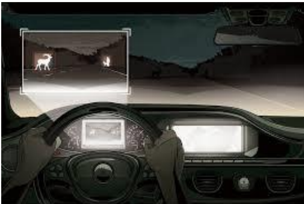
Figuur 18: In-car infrarood detectiesysteem
