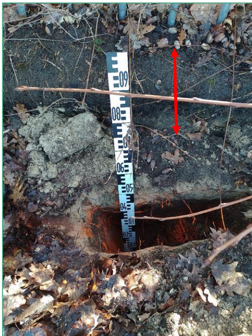
Afbeelding 3.2 met rood aangegeven eerder afgegraven grond.
