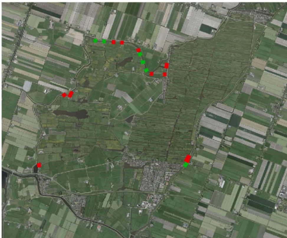
Figuur 2: Oordelen hoogtoets dwarsprofielen (groen=voldoet, rood= voldoet niet)
