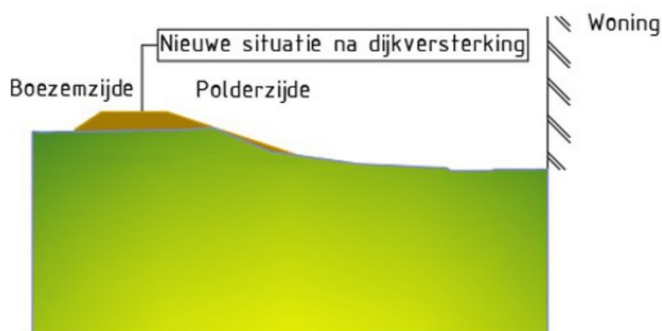
Figuur 10: Principeoplossing ophoging tuimelkade Eilandspolder kadevak 3.1a
