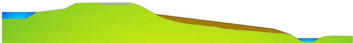
Figuur 13: Principeoplossing grondaanvulling binnentalud Eilandspolder
