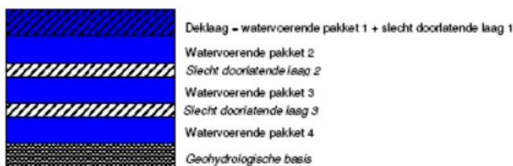
Figuur B2: Conceptueel model van de vier modellagen die gebruikt zijn voor het modelleren van de verzadigde zone (ModFlow) (uit: Snepvangers et al., 2008).
