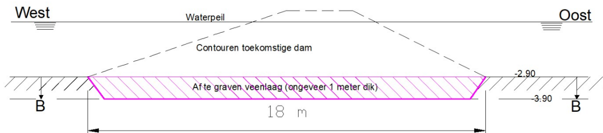
Afbeelding 4 Onderliggende veenlaag afgraven.
