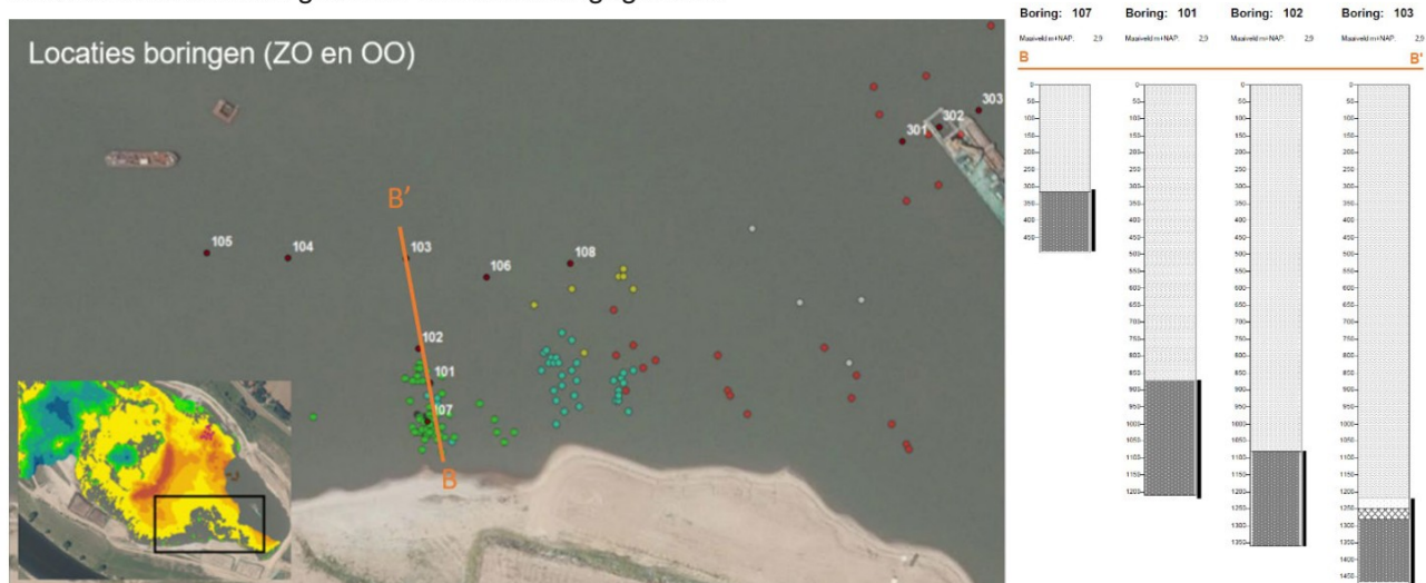
Afbeelding 5.6 Links, controleboringen deellocatie ZO en OO Westplas inclusief loslocaties granuliet, rechts profielen boringen raai B – B'
