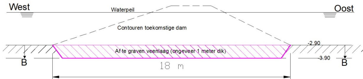
Afbeelding 4 Onderliggende veenlaag afgraven.
