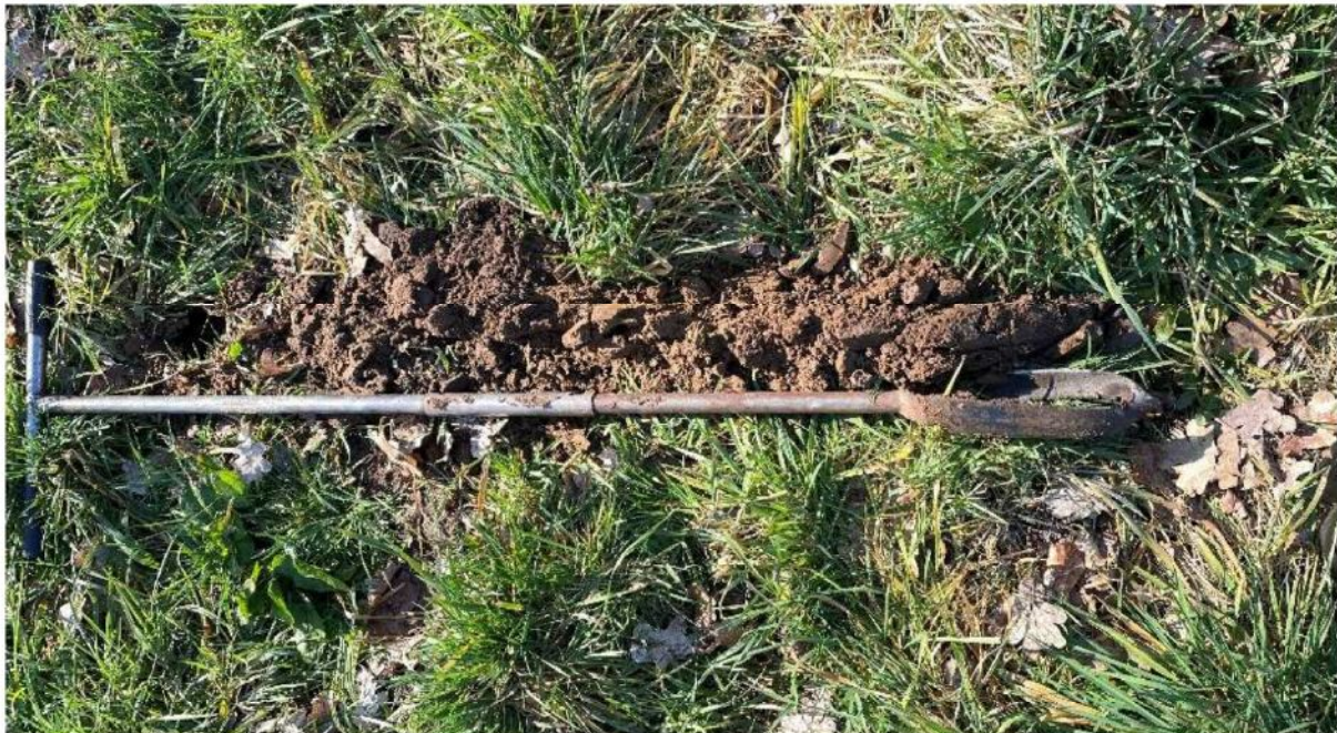
Boring 750mm diep. Goeie vaste grond, pas op 700mm zien we tekenen van roest
