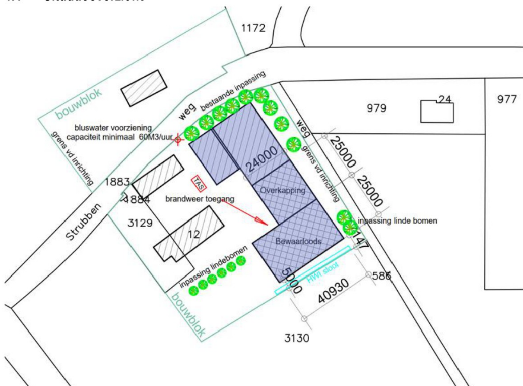
Figuur 1: terrein overzicht met NEN 6060 brandcompartiment aanduiding
