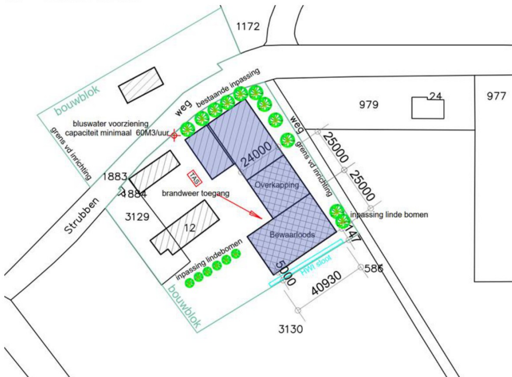
Figuur 1: terrein overzicht met NEN 6060 brandcompartiment aanduiding
