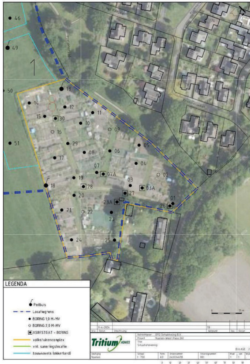
Figuur 2.1: luchtfoto onderzoekslocatie nader bodemonderzoek
