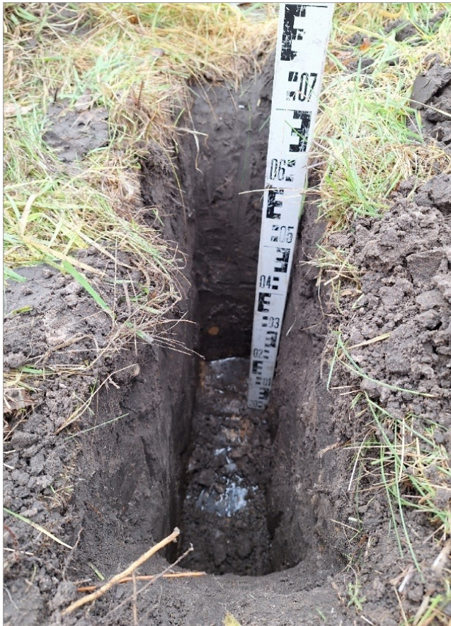
foto 12: Kuil 2 Matig humeus geen beworteling aangetroffen, grondwaterstand op 65 cm diepte.
