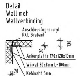
Detail Wallverbinding met kabel kelder
